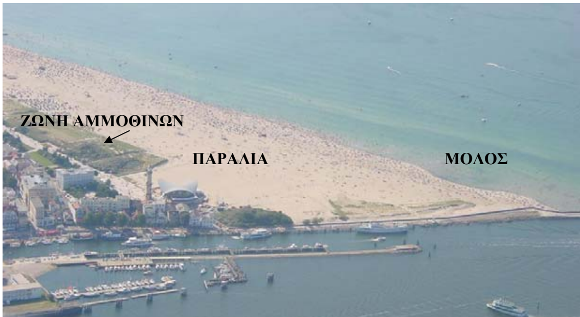
Εικόνα 4.18 Αεροφωτογραφία του ανατολικού τμήματος της ακτής όπου παρατηρείται ανύψωση των αμμοθινών Πηγή: Kammler, 2003 σε Korfer, 2006
